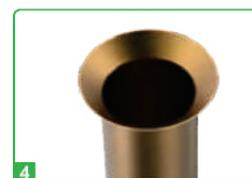
4 Completa el avellanado a 45° de la tubería de cobre
