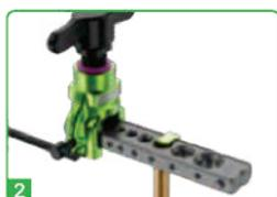
2 La tubería de cobre se inserta en el agujero, y se ajusta con el tope lateral
