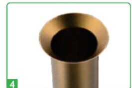
Completa el avellanado a 45° de la tubería de cobre
