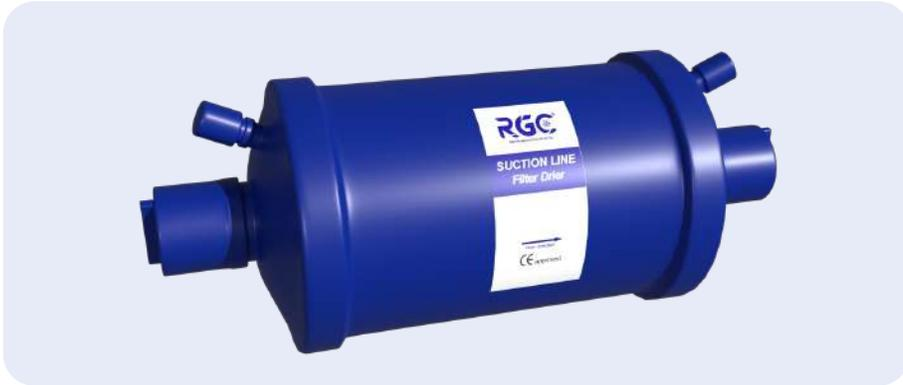
Los filtros de línea de succión RGC de la serie FDF se utilizan para proteger el compresor de la suciedad y todos los contaminantes sólidos que hay en el sistema luego de reemplazar un compresor quemado. Cuenta con válvulas de servicio en entrada y salida para una rápida medición de la caída de presión.
