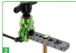
La tubería de cobre se inserta en el agujero, y se ajusta con el tope lateral
